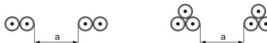
Fig. G18: Factores de reducción para más de un circuito, cables unifilares o multiconductores extendidos directamente en tierra. Método de instalación D (tabla 52-18 de IEC 60364-5-52).
