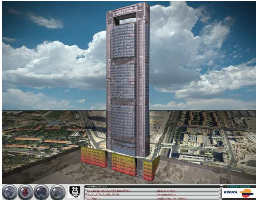
Sistema de gestión centralizado BMS
